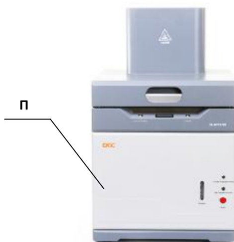
Рисунок 1 – Общий вид анализатора летучих веществ СКІС серии 5E-MVC (позиция «П» обозначает место нанесения знака поверки)
