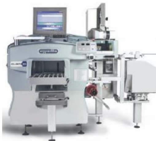
В) АВУ на базе упаковочной машины ELIXA 35 LIBRA
