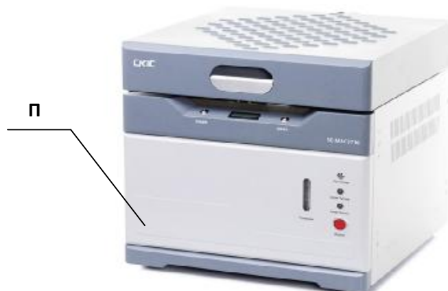
Рисунок 1 – Общий вид анализатора термогравиметрического СКИС серии 5E-МАС (идентичен для двух модификаций, позиция «П» обозначает место нанесения знака поверки)
