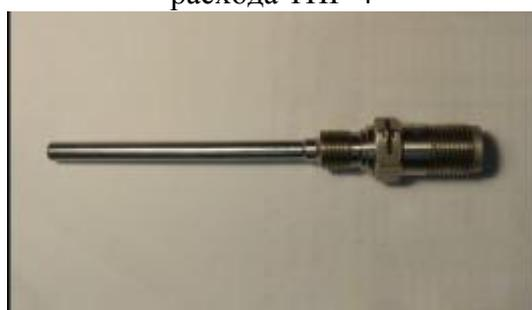
Рисунок 12 – Термопреобразователь
