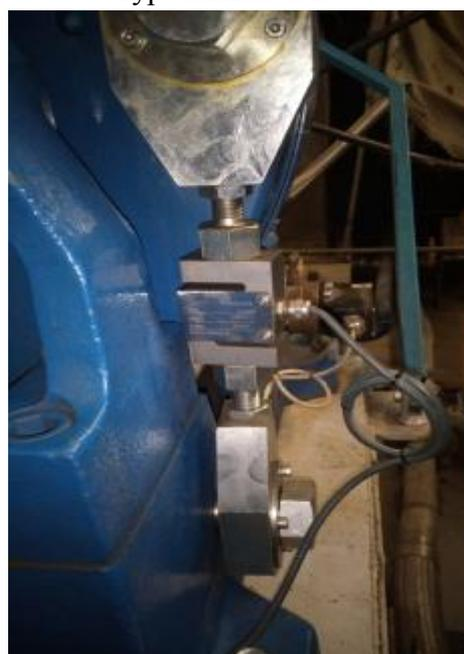
Рисунок 14 – Тензометрический датчик U4000 в
