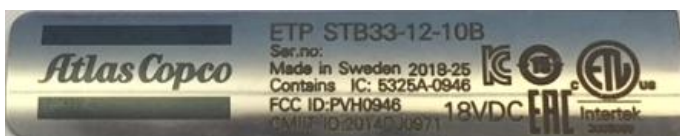
Рисунок 35 - Общий вид типовой маркировки (заводской таблички) гайковертов модификаций с индексом STB
