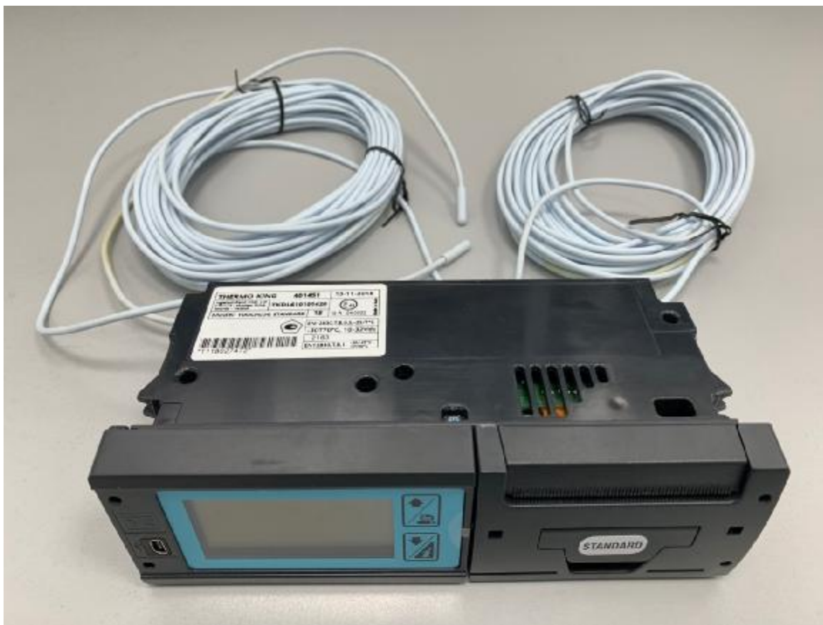
Рисунок 5 – Регистратор TOUCHLOG с 2-мя подключенными датчиками температуры кабельного типа
