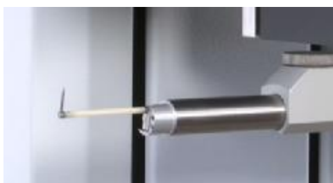
Рисунок 5 – Разворот щуповой системы на 180°
