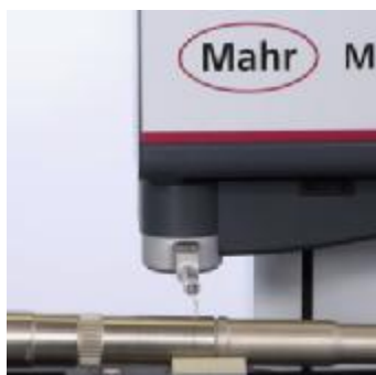
Рисунок 4 – Поворот щуповой системы на 90°
