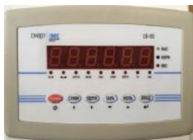
Рисунок 2 — Внешний вид и схема пломбирования весоизмерительного прибора СВ-05
