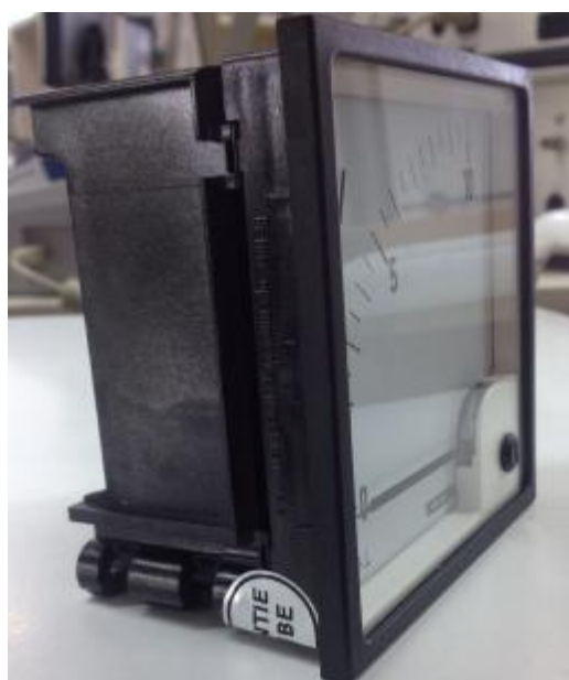
Рисунок 6 - Место пломбирования прибора наклейкой в диэлектрическом пластиковом корпусе
