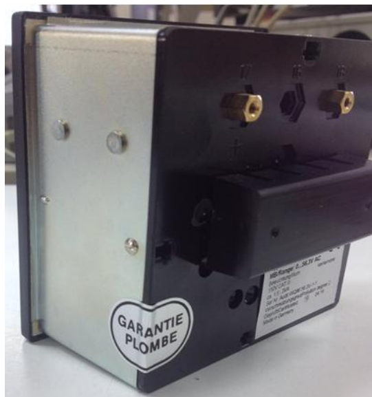
Рисунок 7 - Место пломбирования прибора наклейкой в корпусе из листовой стали
