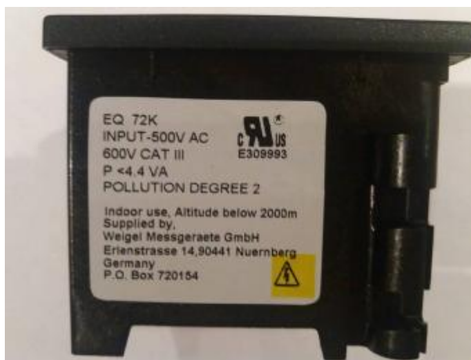
Рисунок 5 - Место нанесения данных о типе и модификации прибора
