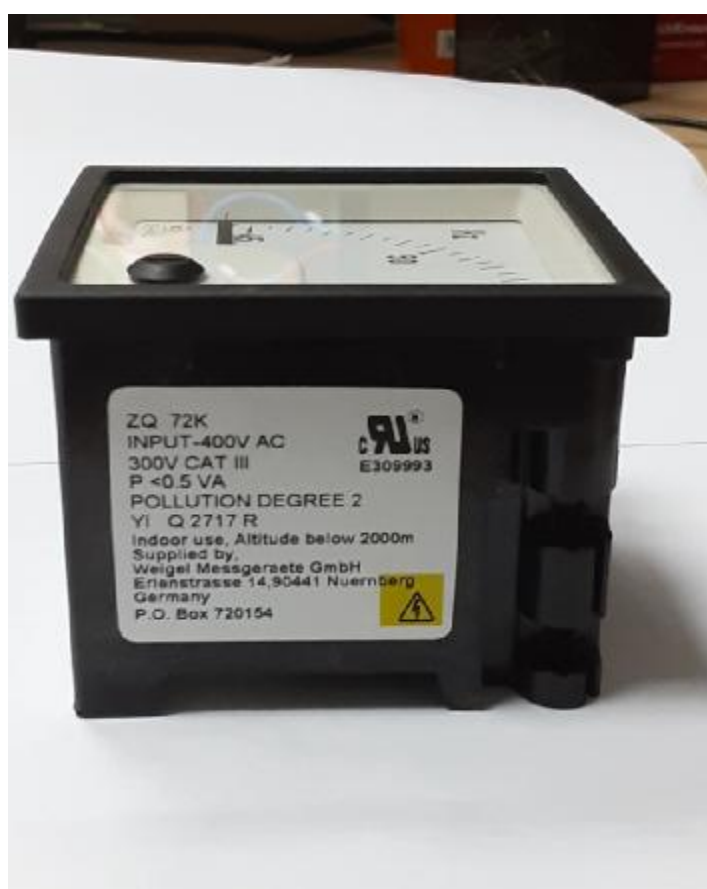
Рисунок 2 - Место нанесения данных о типе и модификации частотомера
