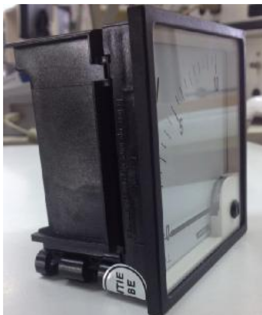
Рисунок 3 - Место нанесения пломбировочной наклейки
