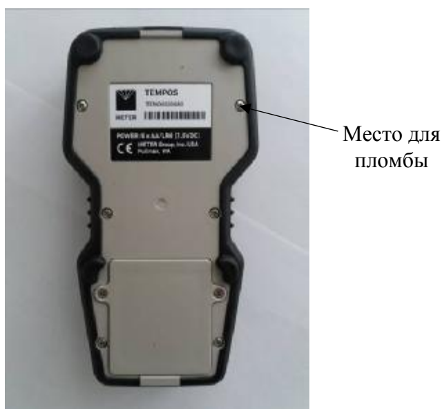
Рисунок 2 – Прибор пример пломбирования, вид сзади
