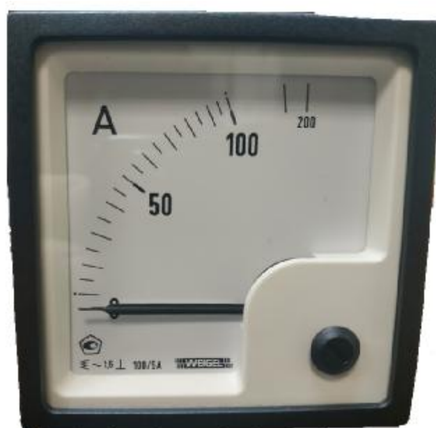
Рисунок 2 – Амперметр с одинарной шкалой
