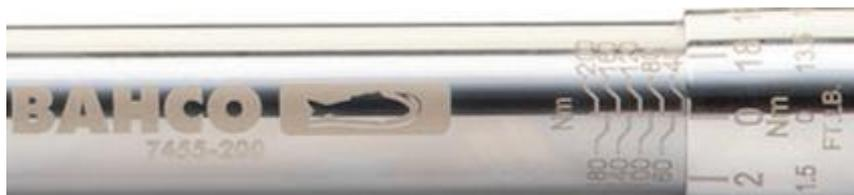
Рисунок 15 – Типовая маркировка ключей моментных предельных ВАНСО серии 7455
