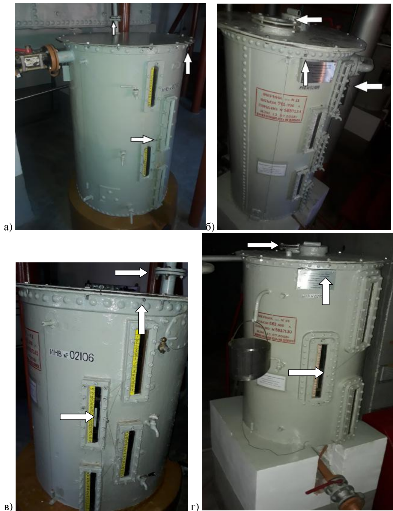
Рисунок 2 – Схема пломбировки мерников ММВ а) заводской №5, б) заводской №11, в) заводской №3, г) заводской №15.
