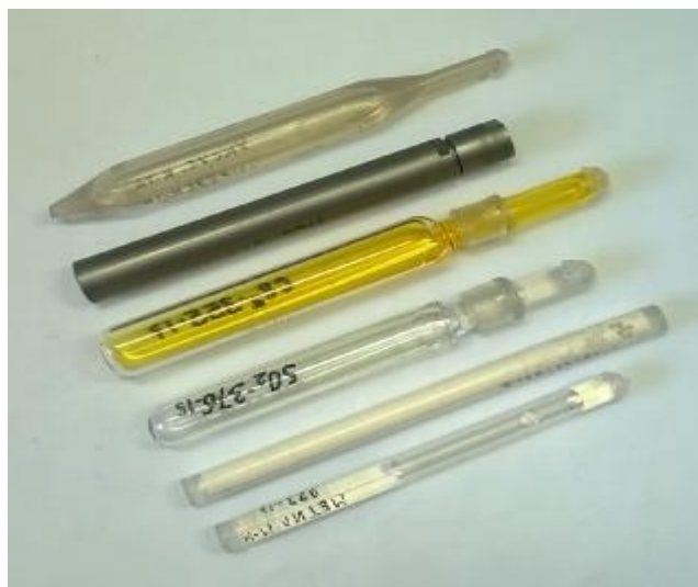
Рисунок 1 – Общий вид источников микропотоков газов и паров ИМ-ЭС различных конструктивных исполнений
