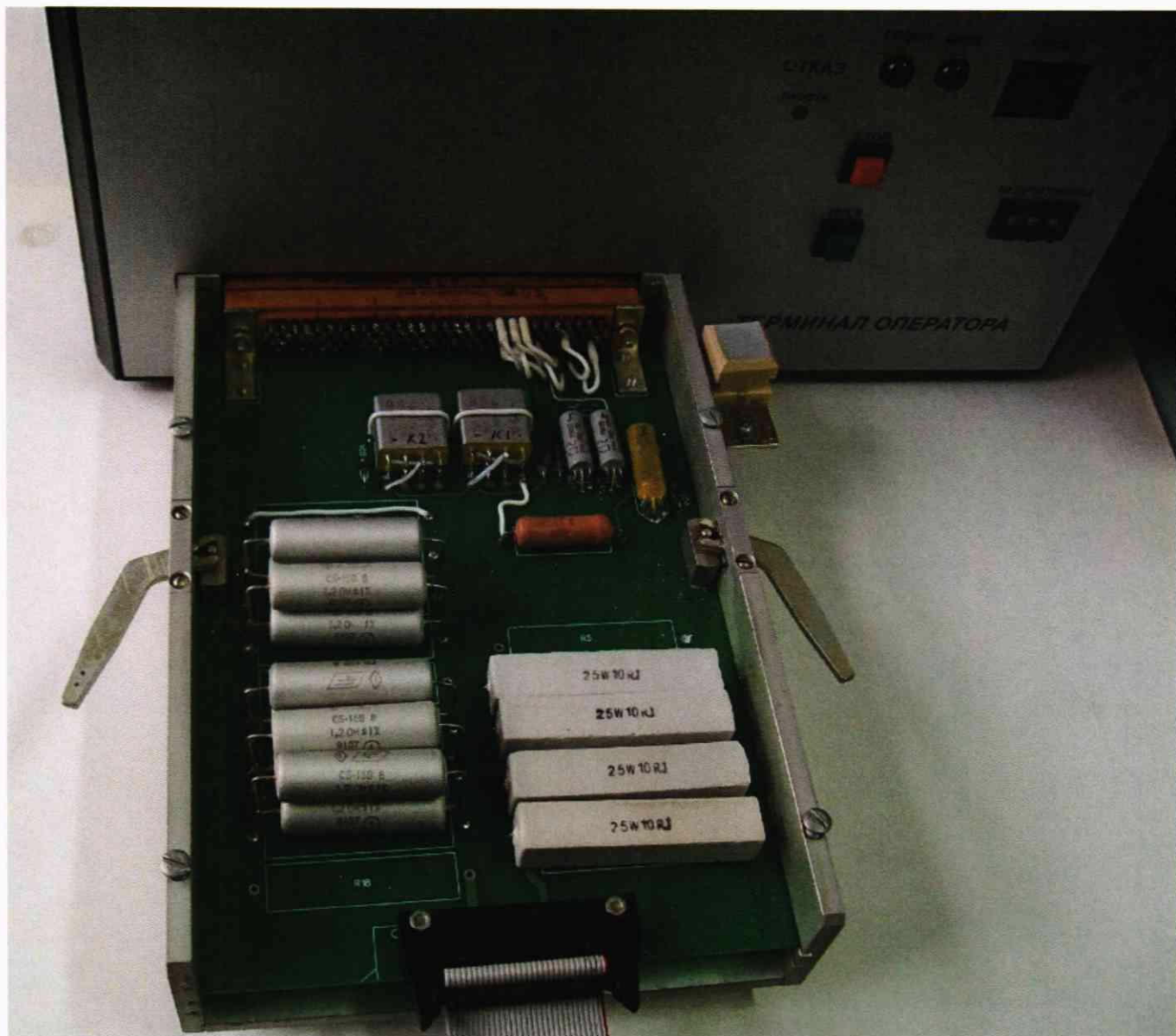
Рисунок 5.5 – Подключение к терминалу оператора платы эталонных нагрузок ПЭН-3 ЯКУЛ.301418.069.
