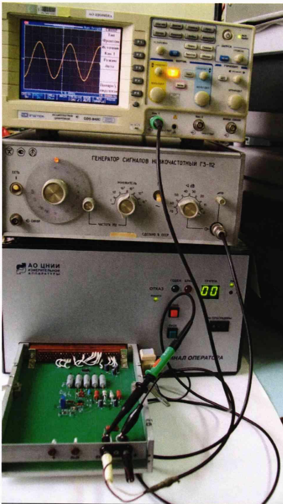
Рисунок 5.17 – Измерение параметров периодического сигнала, формируемого ГЗ-112, эталонным осциллографом GDS-840C и адаптером контроля АЦП-50, подключенным к узлу выходного разъема РМ1 тестера.
