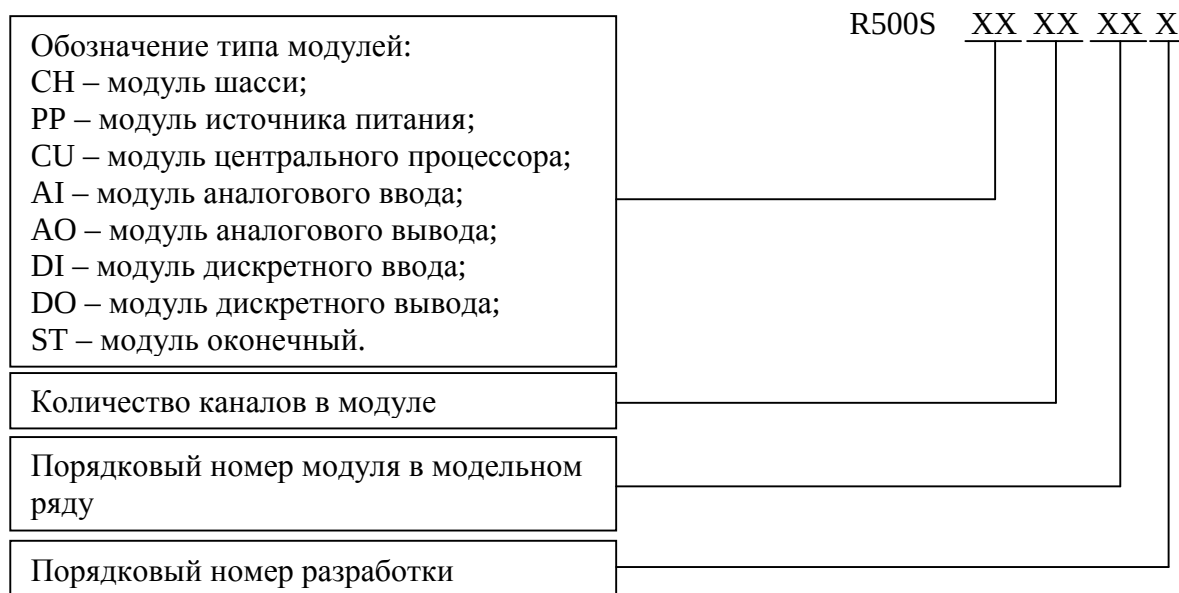
Рисунок 1 – Структура условного обозначения контроллеров
