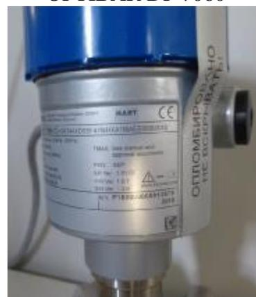
Рисунок 6 – Место нанесения пломбы на корпус преобразователя
