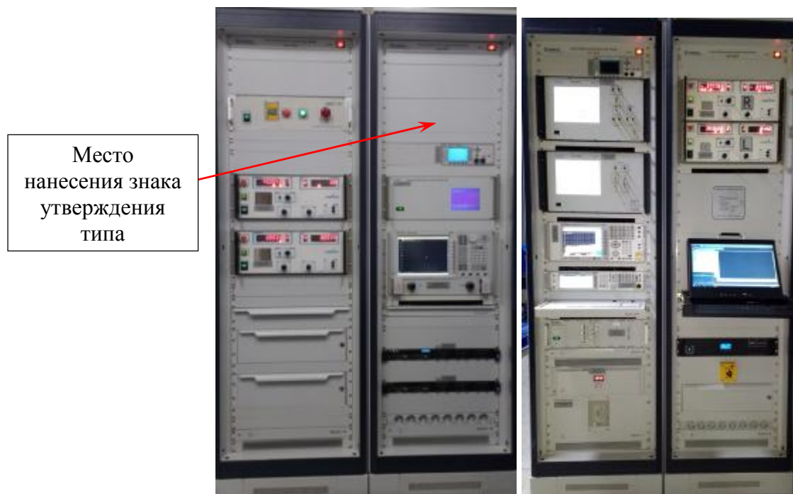
Рисунок 8 – Общий вид аппаратных стоек с радиочастотным оборудованием (в центре) и контроллерами позиционеров (по краям)
