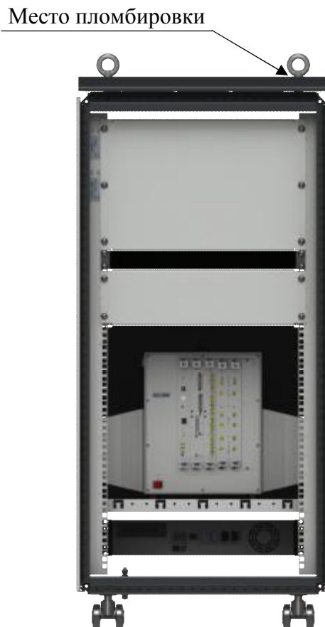
Рисунок 2 – Схема пломбировки от несанкционированного доступа системы автоматизированной измерительной УКиДВ
