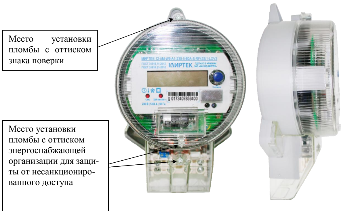
Рисунок 6 – Общий вид счетчика и схема пломбировки от несанкционированного доступа в корпусе типа W9
