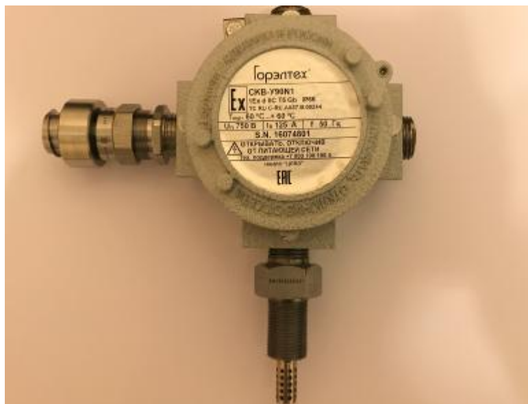
Рисунок 1 - Общий вид преобразователя сорбционно-емкостной температуры точки росы по влаге в природном газе «Гигросенс»
