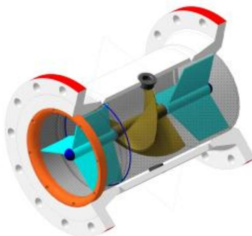
Рисунок 1 – Общий вид ТПР в разрезе
