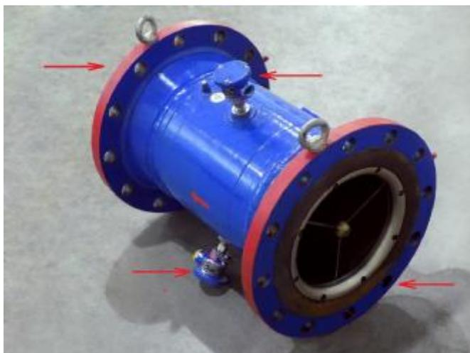
Рисунок 2 – Фото ТПР с местами установки пломб
