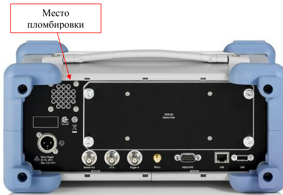
Рисунок 3 - Схема пломбировки анализаторов аэронавигационных систем EVSG1000 от несанкционированного доступа
