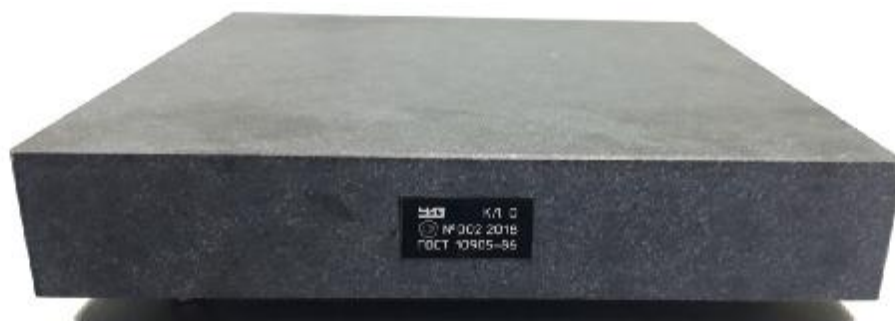
Рисунок 3 – Общий вид плиты поверочной и разметочной исполнения 3
