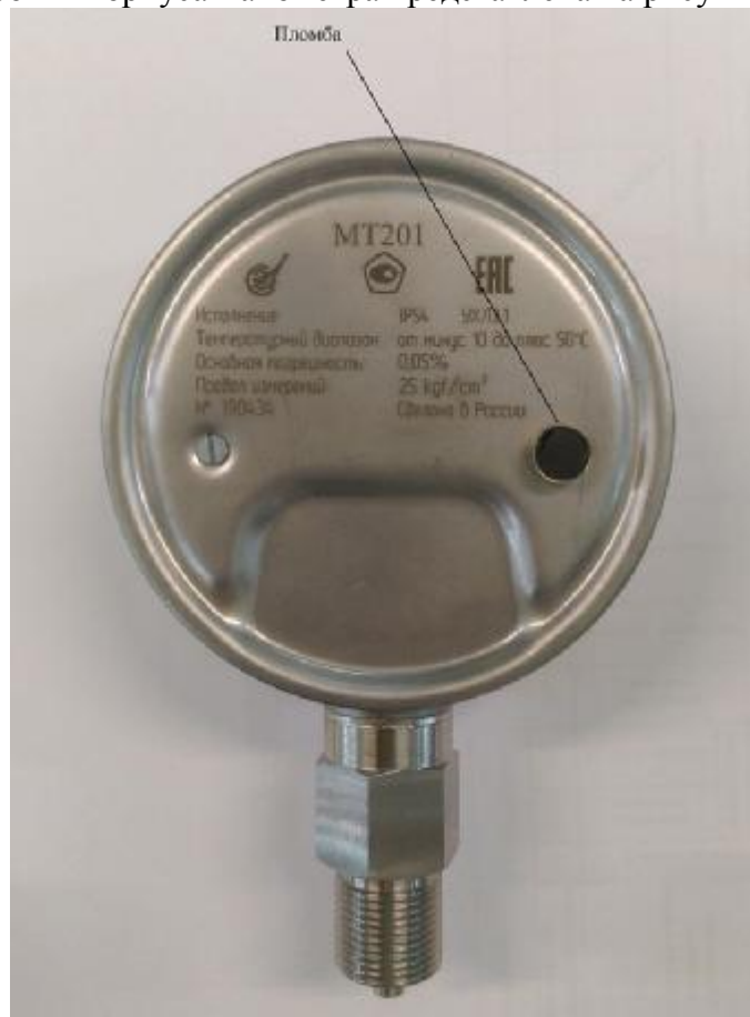
Рисунок 2– Схема пломбировки корпуса манометров цифровых MT201
