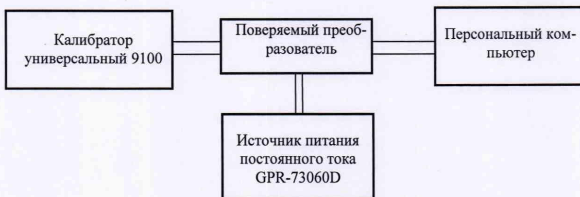
Рисунок 1 – Схема структурная определения погрешностей измерений преобразователей
