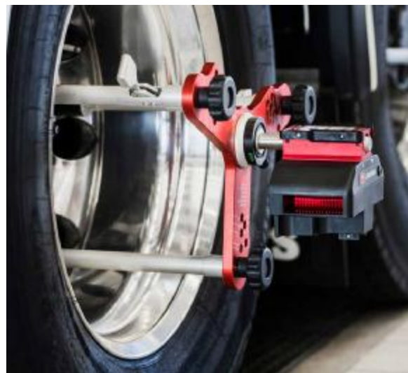
Рисунок 2 - Общий вид устройств для измерений углов установки колес грузовых автотранспортных средств серии I-Track II PREMIUM, модификаций FIXED PREMIUM, MOBILE PREMIUM
