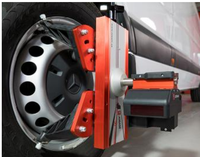
Рисунок 1 - Общий вид устройств для измерений углов установки колес грузовых автотранспортных средств серии I-Track, модификаций JT FIXED К II, JT MOB К II, JT MOB К, JT FIXED К, серии I-Track II CLASSIC, модификаций FIXED CLASSIC, MOBILE CLASSIC
