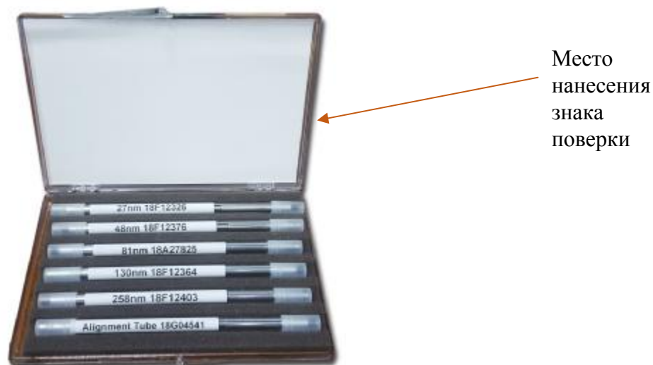
Рисунок 2 – Обозначение места нанесения знака поверки
