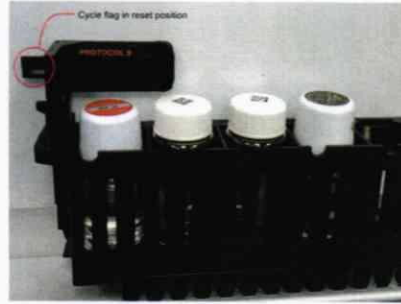
Рисунок 3 – Измерительная кассета с рабочим положением флажкового наконечника
