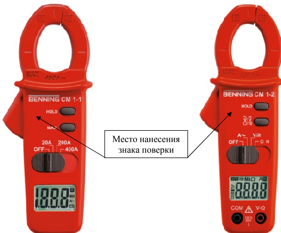
Рисунок 5 – Общий вид клещей токоизмерительных BENNING CM 1-1
