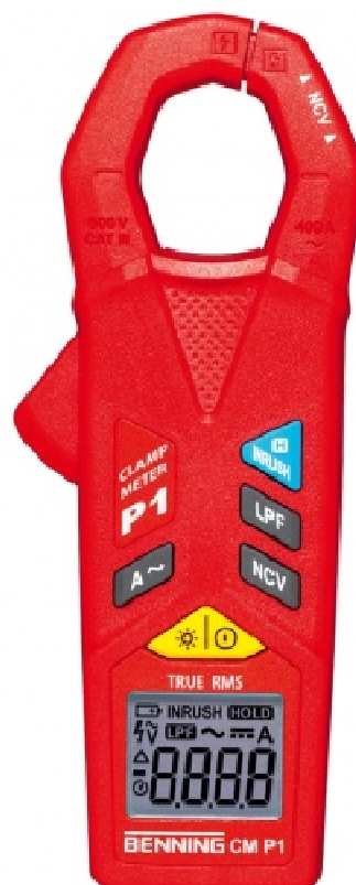
Рисунок 8 – Общий вид клещей токоизмерительных BENNING CM P1
