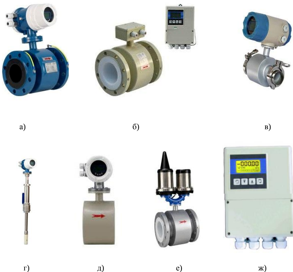
Рисунок 1 – Расходомеры электромагнитные MGG (интеллектуальные): а) MGG/IF – фланцевый интегральный, б) MGG/CF – фланцевый раздельный, в) MGG/IS – санитарный, г) MGG/ID – вставной интегральный, д) MGG/IO – обжимной интегральный, е) MGG/CFA – фланцевый с автономным питанием, ж) электронный преобразователь для раздельного исполнения
