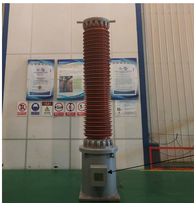
Рисунок 2 – Общий вид трансформаторов исполнения JDQXF-220 с указанием места пломбирования от несанкционированного доступа
