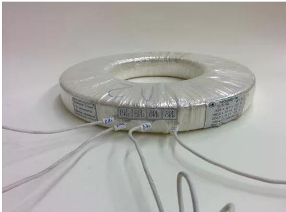
Рисунок 1 – Общий вид трансформаторов
