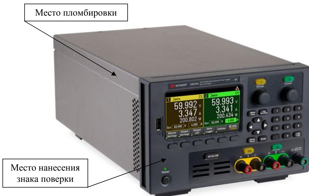
Рисунок 3 – Схема пломбировки от несанкционированного доступа, обозначение места нанесения знака поверки
