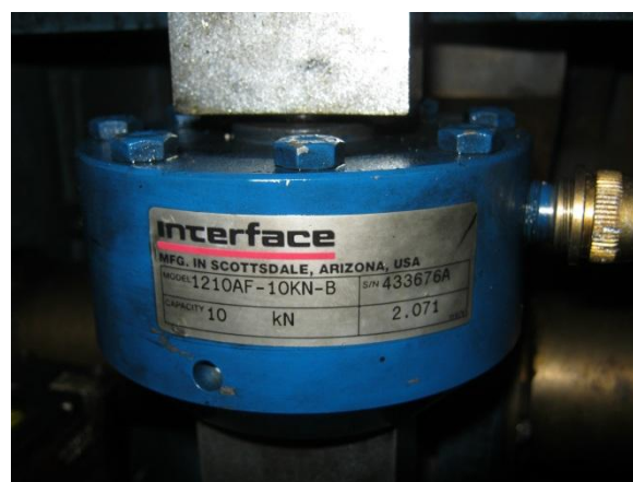
Рисунок 15 – Датчик тензометрический 1210AF-10KN-B в составе динамометра Froude-Hofmann HS-2600
