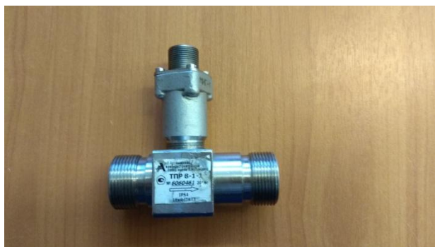
Рисунок 12 – Турбинный преобразователь расхода ТПР-8
