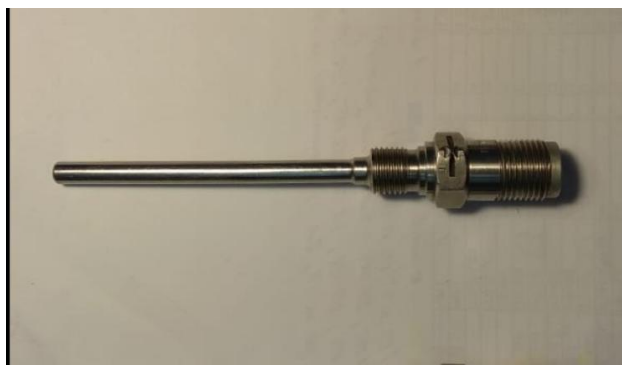
Рисунок 8 – Термопреобразователь сопротивления П-77
