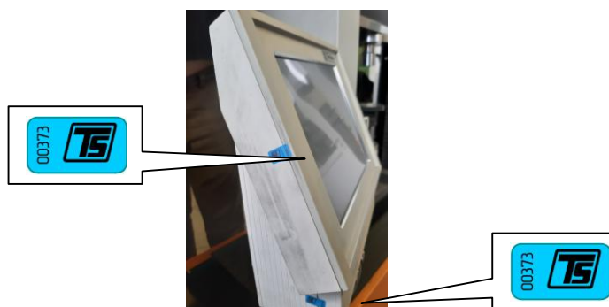
Рисунок 2 – Схема пломбировки пульта оператора от несанкционированного доступа
