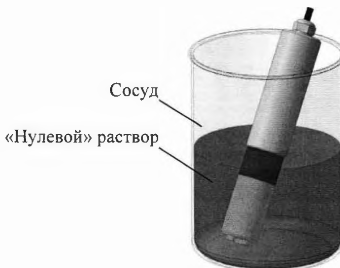
Рисунок 2.4 – Проверка реакции датчика на кислород с помощью «нулевого» раствора
