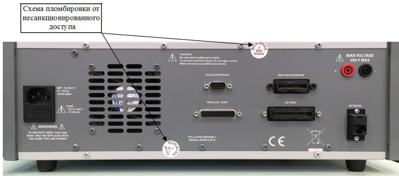
Рисунок 2 — Схема пломбировки от несанкционированного доступа
