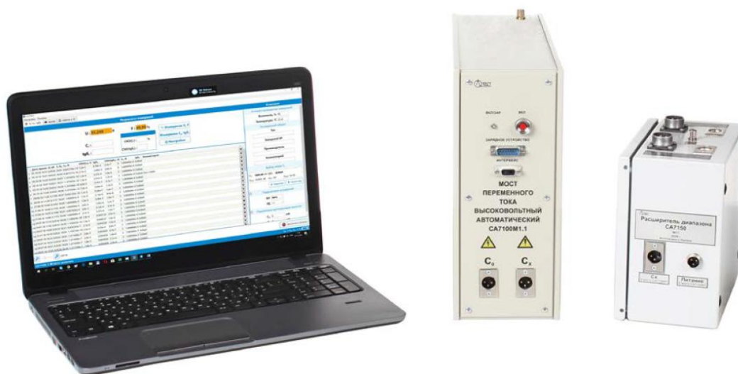
Рисунок 2 – Общий вид моста СА7100М1.1 с расширителем диапазона СА7150 и ноутбуком
