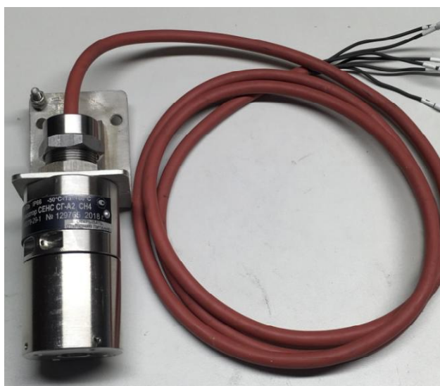
Рисунок 1 – Внешний вид газосигнализатора с вариантом исполнения с КСВЗ
