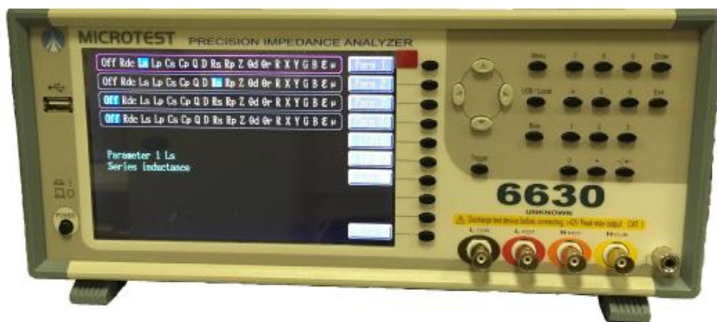
Рисунок 1 - Общий вид анализаторов импеданса прецизионных серии 6630
