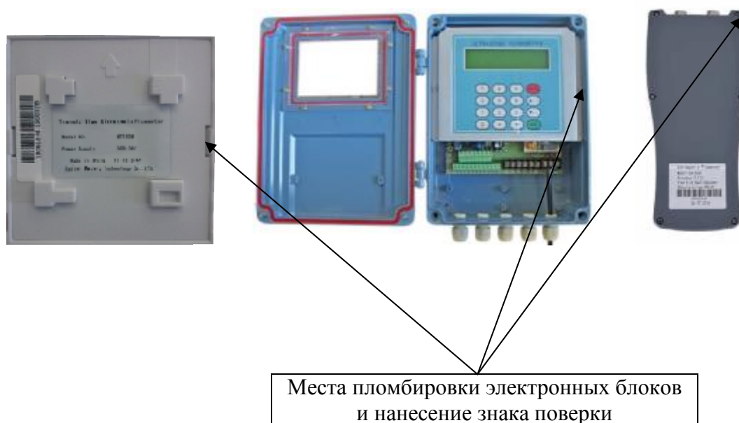
Рисунок 2 – Схема пломбировки электронных блоков от несанкционированного доступа, обозначение мест нанесения знака поверки
