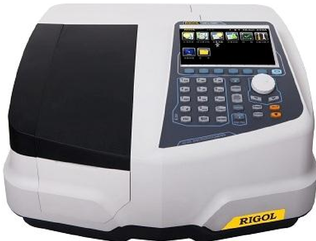
Рисунок 1 - Общий вид спектрофотометров Ultra-3660
