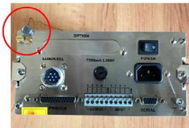
Рисунок 2 – Схема пломбировки CI-5010A от несанкционированного доступа
