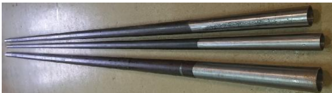
Рисунок 1 – Общий вид мер с искусственными дефектами 452.008
