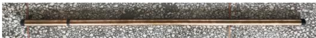
б) забойная часть инклинометра «LHE 6218A» - 40мм
