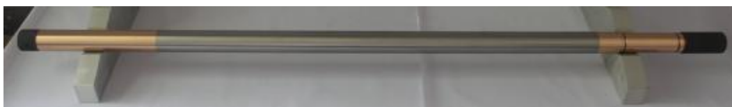
а) забойная часть инклинометра «LHE 6118» - 48мм
