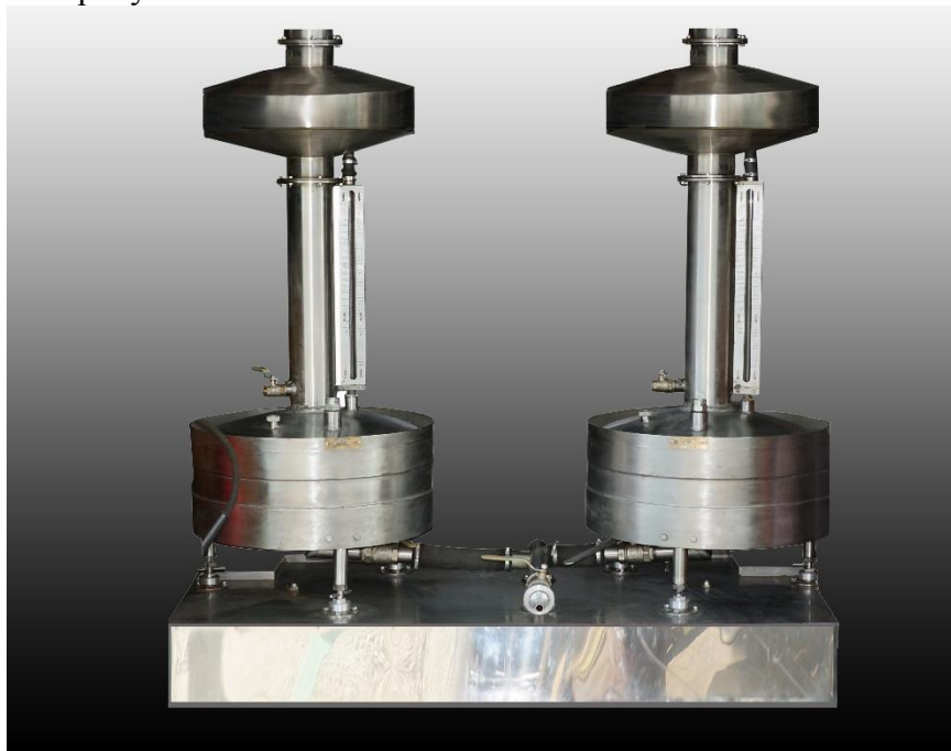
Рисунок 1 – Общий вид установок поверочных передвижных средств измерений объема жидкости ППЛ
