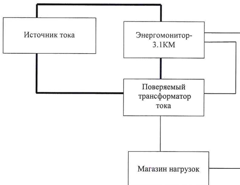
Рисунок 2 – Структурная схема определения погрешностей трансформаторов при значении номинального тока 0,2 % с использованием Энергомонитора 3.1KM
