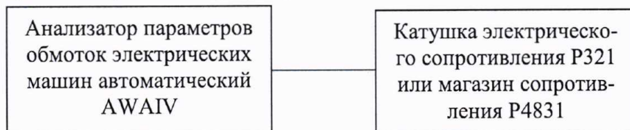
Рисунок 3 – Схема подключений для определения погрешности измерений электрического сопротивления
